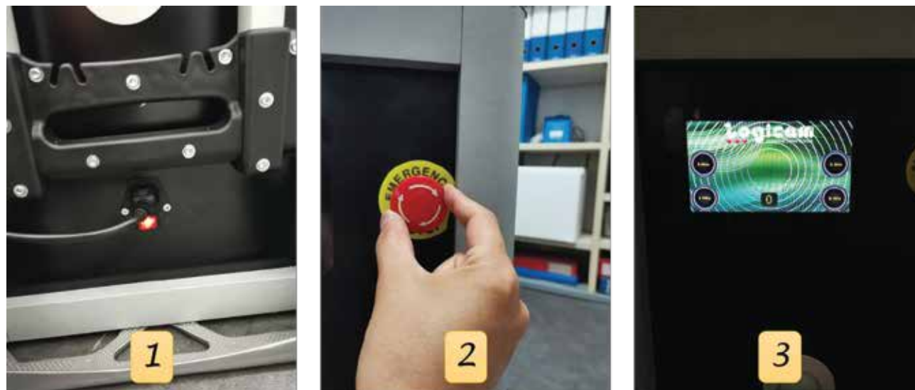
Figura 2 - Istruzioni per l'utente in passi. Dopo la selezione del timer al passo 3, il dispositivo si accenderà automaticamente dopo 1 minuto per consentire all'operatore di uscire dalla stanza.
